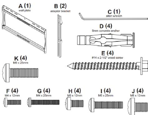
*Ce produit est pensé pour une installation sur des murs à montant en bois, béton plein ou en bloc de béton. Assurez-vous préalablement que la surface de support peut soutenir sans danger la charge totale.*
