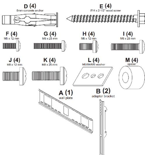
*Ce produit est pensé pour une installation sur des murs à montant en bois, béton plein ou en bloc de béton. Assurez-vous préalablement que la surface de support peut soutenir sans danger la charge totale.*
