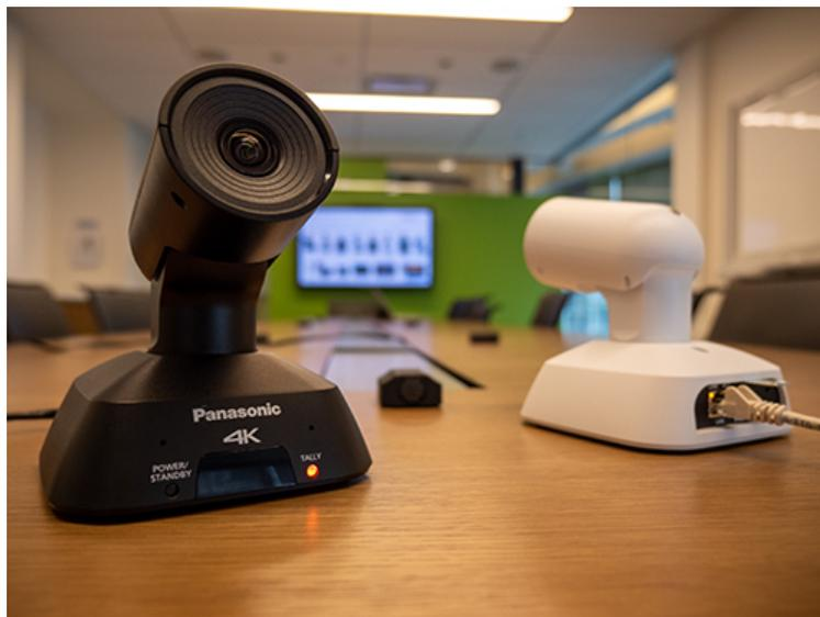
L'unité prend en charge l'alimentation PoE\* et peut être utilisée comme caméra USB, alimentée depuis un ordinateur. Elle offre ainsi une solution câblée unique pour la transmission vidéo, le contrôle caméra et l'alimentation électrique.
