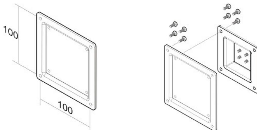
L'adaptateur VESA NewStar, modèle FPMA-VESA100 est adapté pour les écrans jusqu'à 30" (76cm). Idéal lorsque l'écran plat nécessite un VESA différent pour être monter sur un mur, un bureau ou au plafond.
