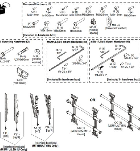
*Ce produit est pensé pour une installation sur des murs à montant en bois, béton plein ou en bloc de béton. Assurez-vous préalablement que la surface d'installation peut soutenir sans danger la charge totale du support et de l'écran.*
