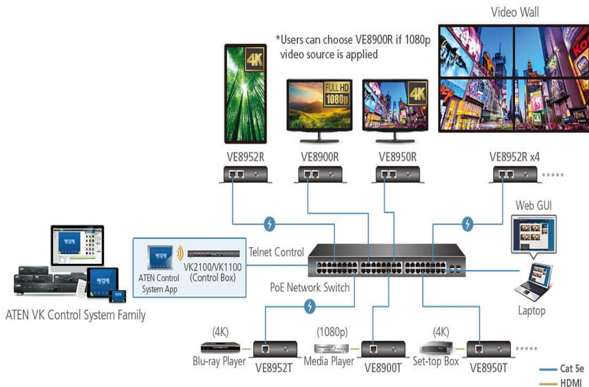
\*Remarque : Le VE8952 prend en charge le PoE et peut être installé en association avec des commutateurs réseau PoE afin de réduire le nombre de câbles d'alimentation et de prises de courant supplémentaires. Avant de choisir le commutateur réseau et l'installation, veuillez consulter le Guide d'implémentation.
