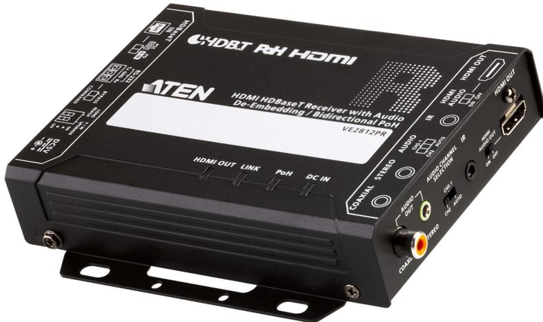
Doté de la puissante technologie HDBaseT de classe A, le VE2812PR est un récepteur pour signaux vidéo, audio et de commande HDMI 4K sur une distance allant jusqu'à 100 m via un câble Cat 5e/6/6a ou Cat 6 [2L-2910](#) d'ATEN. La transmission du signal HDMI s'étend jusqu'à 150 m à 1080p lorsque le Long Reach mode HDBaseT est activé.
